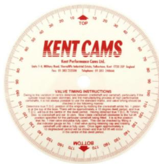
**Disque gradué** : réglage des arbres à cames
