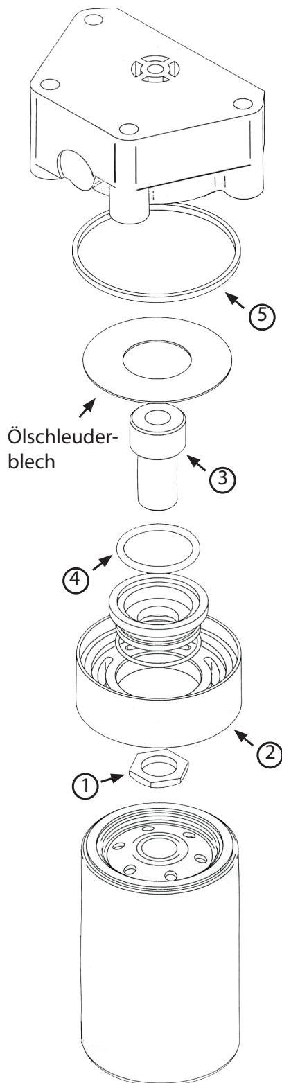
Der Ölfilteradapter besteht insgesamt aus 3 Teilen, einem Innenteil, einem Außenteil und einem O-Ring. Diese werden ineinander geschoben, um die leichten Unregelmäßigkeiten im Ölfilterkopf auszugleichen.
