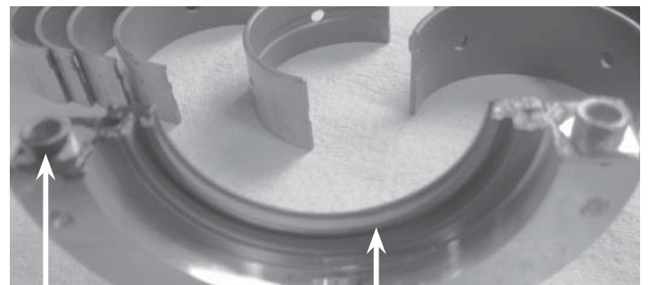
8. Streichen sie die Kurbelwelle, dort wo die Simmerring- Hälften Kontakt mit der Kurbelwelle haben werden, mit etwas Fett ein.
