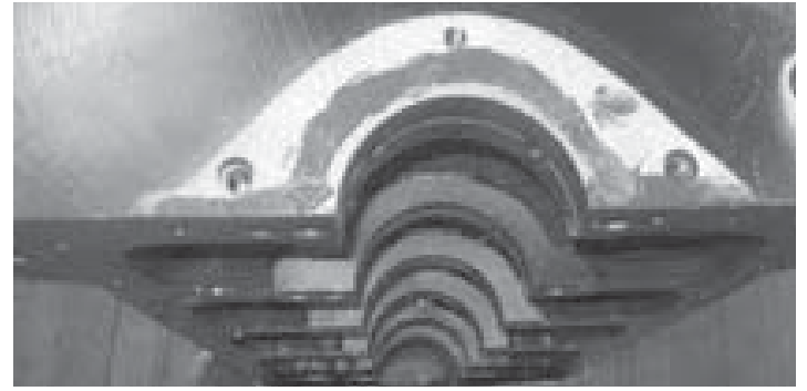
4. Legen Sie eine dünne Schicht ATV Dichtmittel auf, um die Simmering - Halbschale gegen den Motorblock abzudichten.
