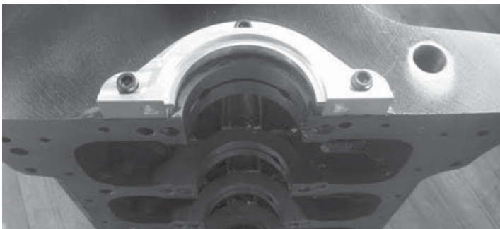
5. Montieren Sie die obere Simmering - Halbschale an den Motorblock. Sichern Sie dabei alle 5/16“ Inbusschrauben mit ein wenig Loctite.
