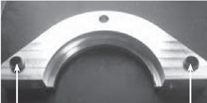
3. Setzen Sie die Führungshülsen in die obere Simmering - Halbschale ein.
