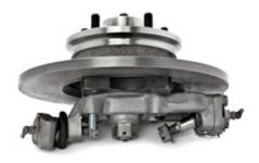
5. Schrauben Sie den Bremssattel an die Trägerplatte. Benutzen sie unbedingt die diesem Satz beigelegten Unterlegscheiben.
