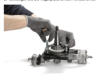
Schrauben Sie die Bremsscheibe mit dem Stahlfelgenflansch zusammen
