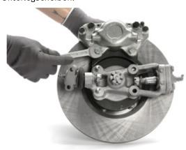
6. Kontrollieren Sie, dass sich die Bremsscheibe frei im Bremsscheibenschacht drehen kann. Dabei sollte sich die Bremsscheibe genau mittig im Schacht befinden.
