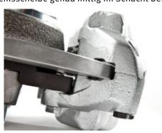
7. Sollte das so nicht der Fall sein, muss der Bremssattel wieder demontiert werden. Fügen Sie nun, die sich in diesem Umbausatz befindlichen Beilagscheiben zwischen Bremszange und Trägerplatte ein, bis sich die Bremsscheibe frei im Bremsscheibenschacht dreht.
