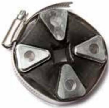
Os parafusos das flanges podem ser facilmente guiados através dos arbustos das arruelas de articulação e montados.
