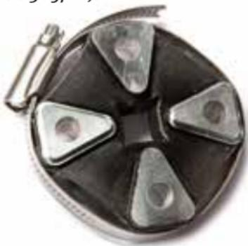
Ainsi précontraints, les boulons des brides peuvent être facilement guidés à travers les douilles des disques d'articulation et montés.
