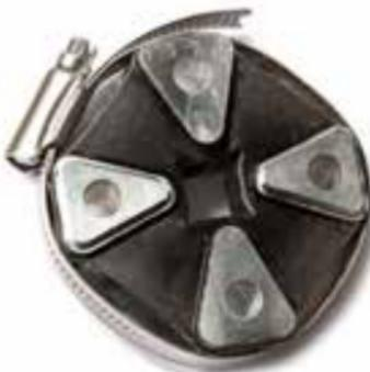
So vorgespannt können die Bolzen der Flansche leicht durch die Buchsen der Gelenkscheiben geführt und montiert werden.
